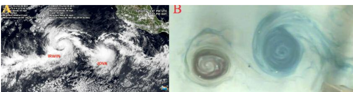
FIGURA 3 En el inciso (A) se muestra una imagen obtenida por satélite de la interacción de dos huracanes ciclónicos sobre el Océano Pacífico frente a las costas de México En (B) se muestra la interacción de dos vórtices generados en la mesa giratoria auto-propagándose hacia el oeste del tanque.
