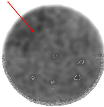
**Figura 7.11.** Control de calidad de uniformidad en PET defectuoso.
