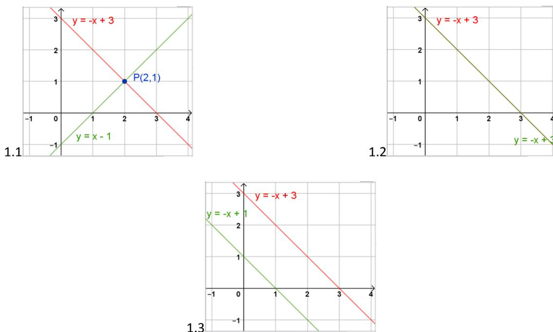
Figura 1: Posibles soluciones de un sistema de dos ecuaciones lineales con dos variables: 1.1 Sistema compatible determinado 1.2 Sistema compatible indeterminado 1.3 Sistema incompatible
