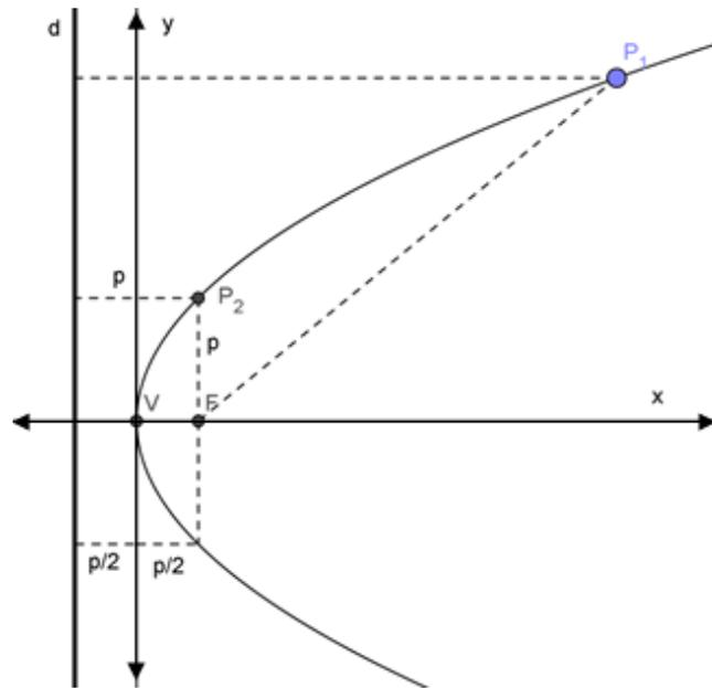
La recta perpendicular a la directriz que contiene al foco ( $F$ ) se llama eje de la parábola o eje de simetría.
