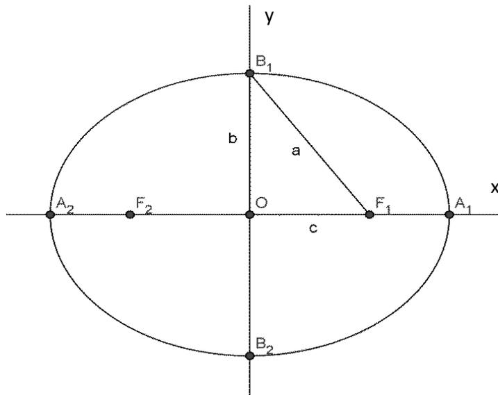
Se puede deducir del triángulo rectángulo  $B_1 \Delta O F_1$  que  $a^2 = b^2 + c^2$
