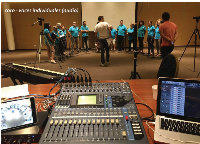
Figura 1. Instalación de la situación experimental desde la consola de audio donde se observa la disposición de los elementos de captura y el registro de las voces en canales por separado.
