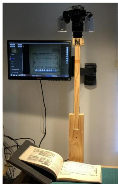
Figura 1: Modelo de escáner con cámara cenital
