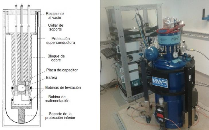
Figura 6.8: Diagrama de la parte criogénica del gravímetro superconductor (Goodkind, 1999) (izq.), e imagen del gravímetro SG038, fabricado por GWR, del Observatorio Argentino-Alemán de Geodesia, AGGO (der.).
