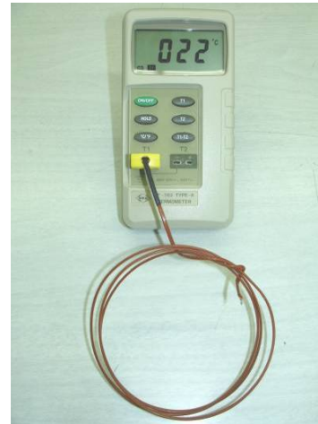
Foto 8-2 Termocupla conectada a un instrumento indicador
