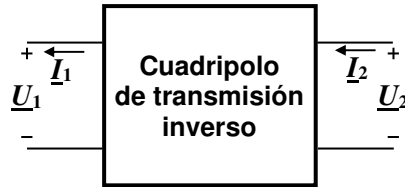
Figura 4-7: Cuadripolo de parámetros \underline{b} con el cambio del sentido de la corriente de entrada
