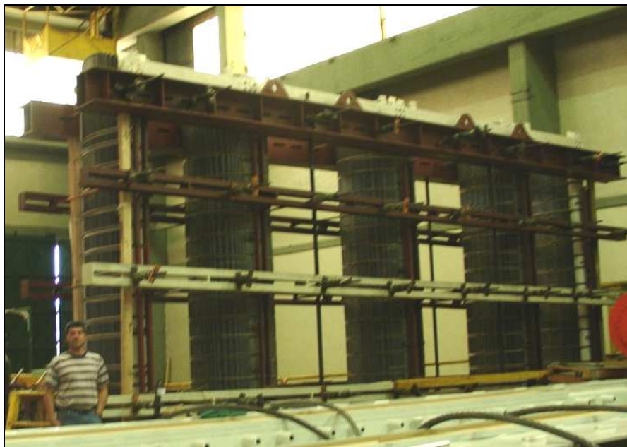
Foto 9-1 Núcleo magnético de un transformador trifásico de potencia
