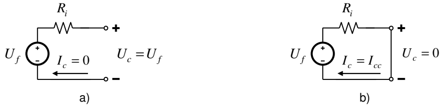
Figura C-5 Condiciones extremas de la característica de regulación de la fuente de Figura C-1.
