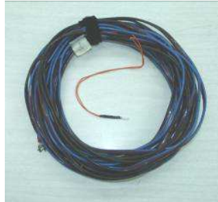
Foto 8-4 Pt100 montada en un cable de tres conductores
