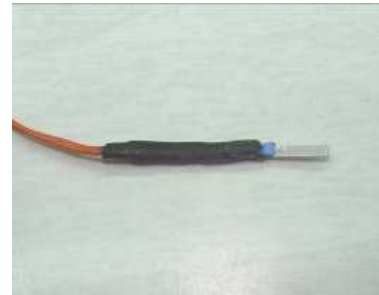
Foto 8-5 Detalle de montaje de la Pt100 en el cable
