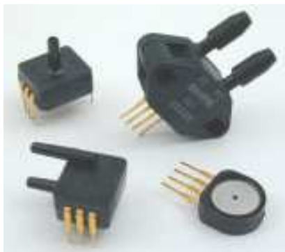
Foto 8-6 Algunos sensores de presión con la escala para comparar tamaños
