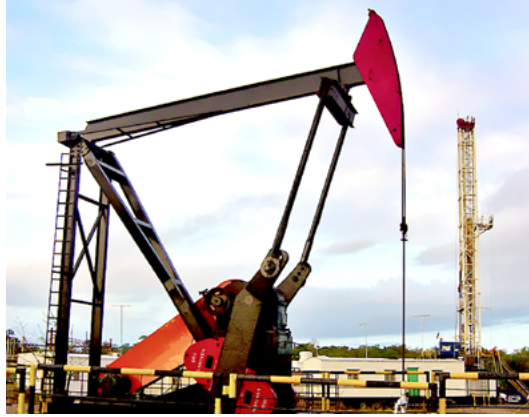
Figura 66. Balancín petrolero y taladro de perforación petrolera. La empresa YPF ha otorgado becas de estudio y brindado oportunidades laborales para los geólogos egresados del MLP, desde su creación hasta el presente. Foto: de Humberto Ríos, Wikipedia.
