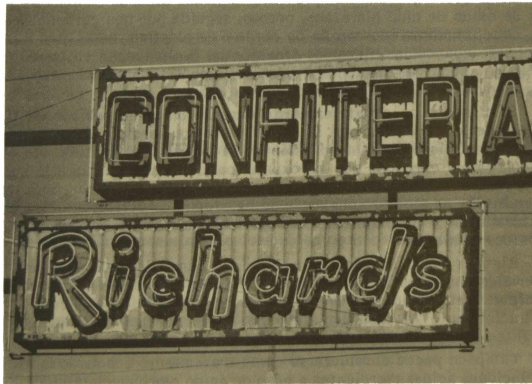
Las fotografías muestran la falta de adhesión de la película de pintura sobre superficies galvanizadas cuando no se emplea un adecuado pretratamiento.
