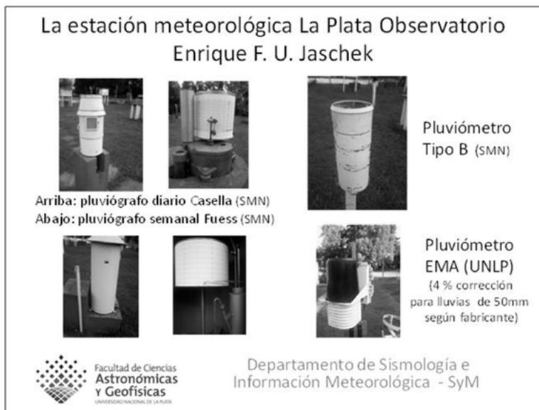
*Figura 1: instrumental de LPO donde se mide y se registra la precipitación. (SMN: instrumental provisto por el Servicio Meteorológico Nacional, EMA: estación meteorológica automática marca Davis)*
