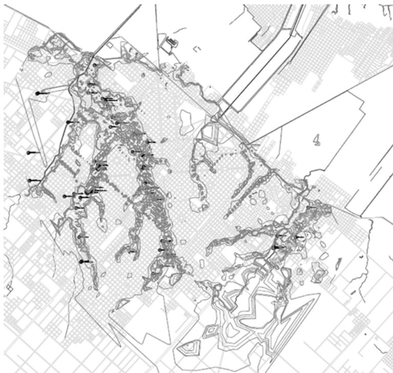
*Figura 7: Mapa de áreas inundables sobre el plano de la ciudad de La Plata, con intensidades de sumersión  $I= 0,35 \text{ m}^2/\text{s}$ ,  $I= 0,40 \text{ m}^2/\text{s}$ ,  $I= 0,60 \text{ m}^2/\text{s}$ ,  $I=0,80 \text{ m}^2/\text{s}$  e  $I=1,20\text{m}^2/\text{s}$ . Los puntos indicados representan las víctimas producto del evento del 2 de abril de 2013.*
