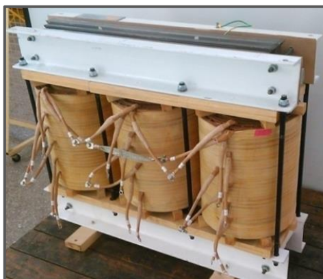
Figura 6. Transformador utilizado para generar fallas artificialmente
