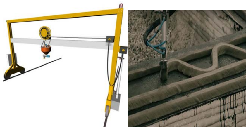
2 Pórtico y cabezal de aplicación
