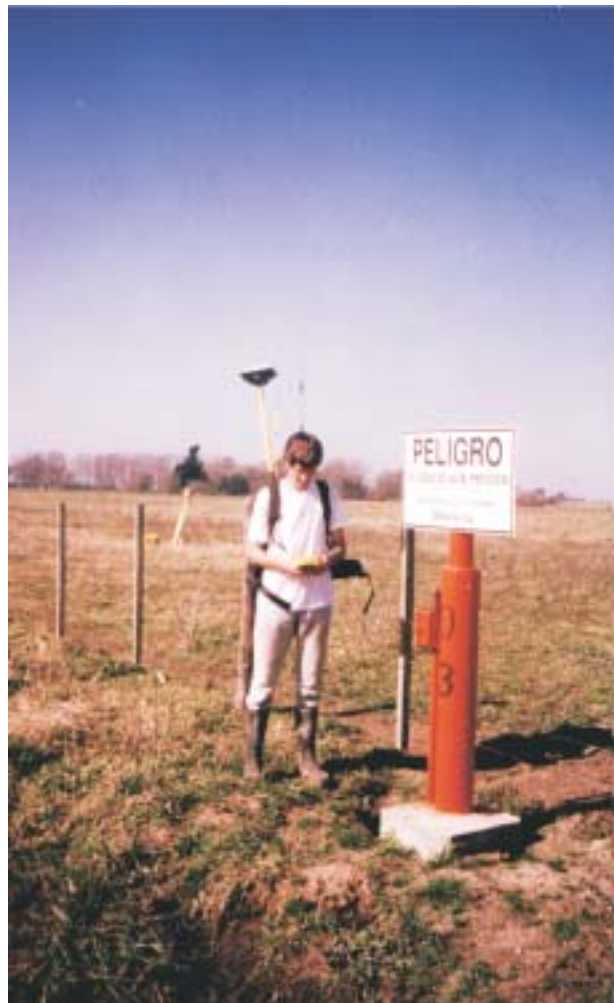
Una de las mediciones realizadas debajo de líneas de alta tensión. La misma no resultó ser un inconveniente ni para las comunicaciones ni para la recepción de satélites. Abajo relevando un oleoducto.
