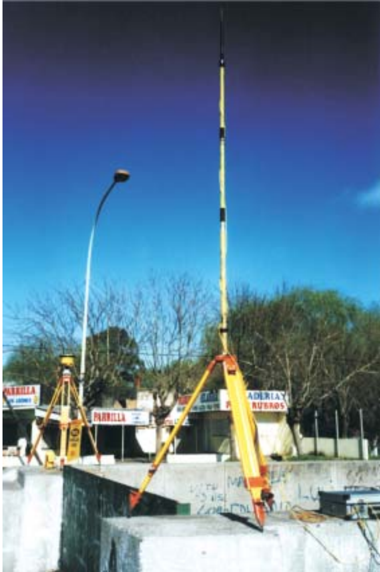
Base RTK estacionada en el punto 2ROT. La antena de transmisión de datos se encuentra lo más elevada posible para optimizar las comunicaciones.
