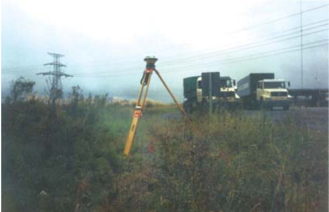
Punto LATE, cercano a una línea de 132 KV. Además en el momento de medición se produjo una tormenta eléctrica. Ni ésta ni la línea de tensión afectaron las mediciones.
