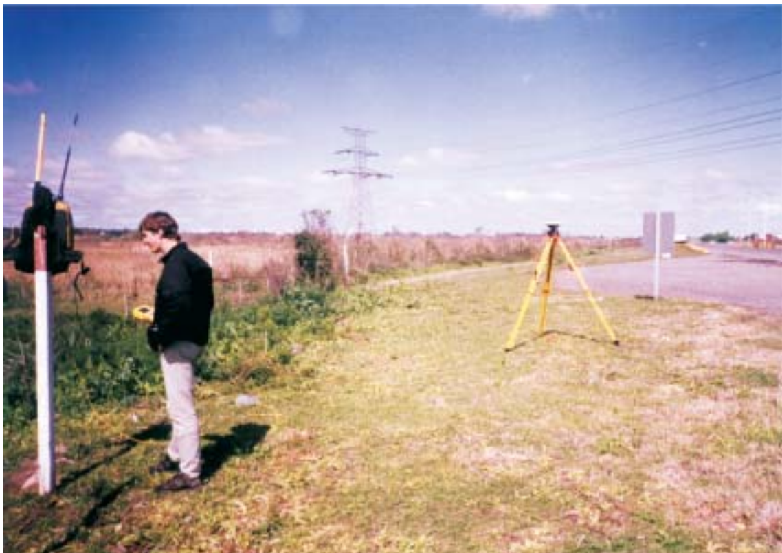
Móvil RTK estacionado en el punto LATE para comprobar la precisión del método. La presencia de la línea de alta tensión no afectó el normal desempeño de los equipos.
