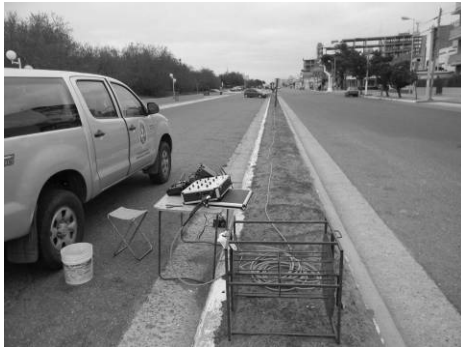
Figura 8. Instrumento de medición y disposición del cable multielectrónico sobre la rambla de Av. Costanera.
