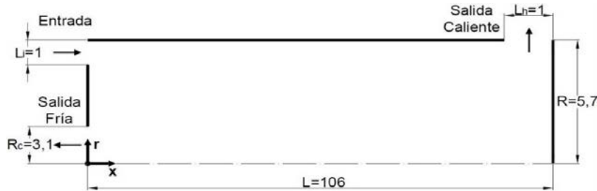
Figura 1. Modelo geométrico (medidas en mm) i representa la entrada, c la salida fría y h la salida caliente.
