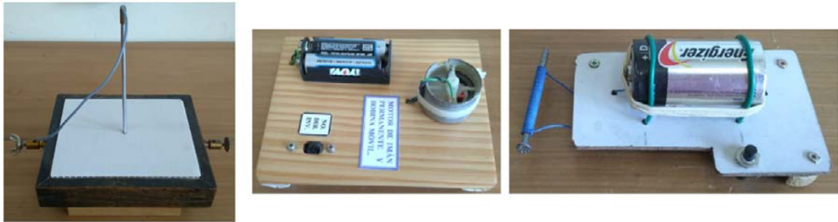
Imagen 4. a. Visualizador de líneas de campo magnético. b. Simulador de motor de corriente alterna. c. Electroimán
