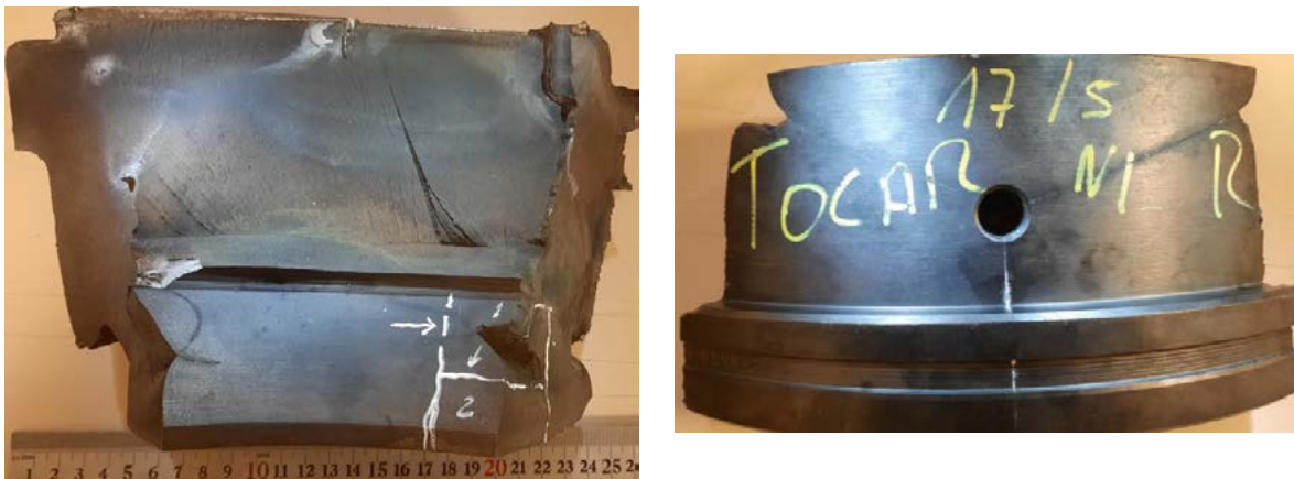
Figura 1 Fotografías de recepción Matriz Fracturada
