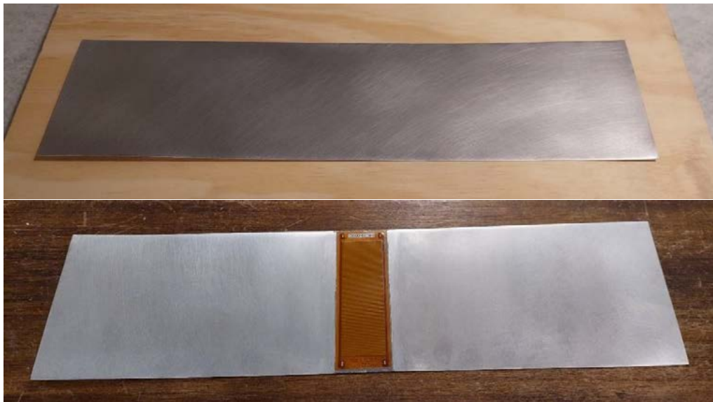
Figura 2. Placa de aluminio de 0.5 mm (arriba). Placa con actuador MFC adherido (abajo).
