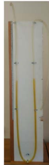
Imagen 2. a. Medidor de presión, tubo en U. b. Medidor de presión de brazo inclinable.
