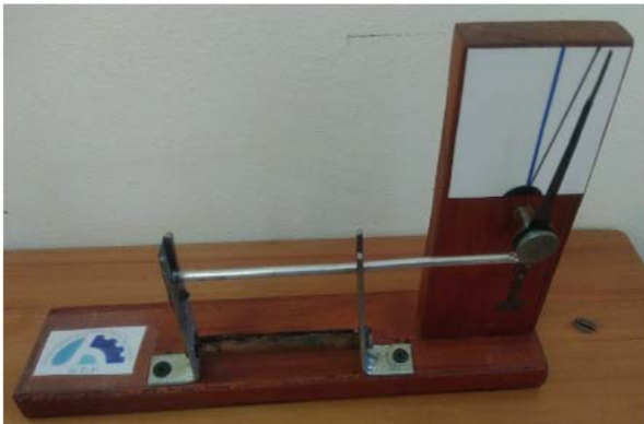
Imagen 1. a. Dispositivo de dilatación térmica. b. Tubo de Venturi con forzador de aire incluido.
