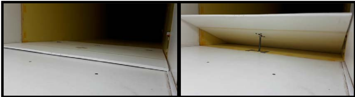
Figura 2 – Dispositivo generador de ráfaga, desactivado a la izquierda, activado a la derecha.
