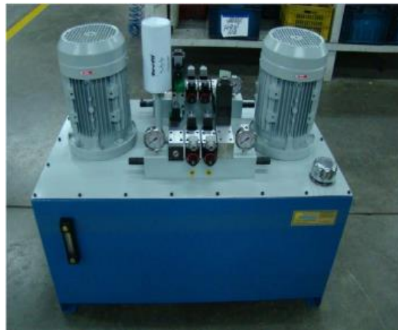
Ilustración 4 – Centralita hidráulica utilizada
