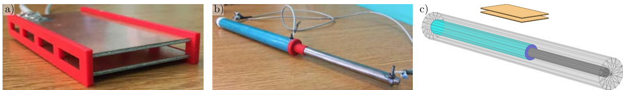
Figura 3: (a) CPP construido, con separadores rojos también realizados en impresión 3D y cables coaxiales soldados a las placas. El dieléctrico se varió midiendo al aire o sumergiendo al dispositivo en una pequeña cuba plástica con líquido. (b) CSC físico, con soportes de plástico impresos en 3D y empalmes eléctricos de tuerca y tornillo. Su material dieléctrico entre electrodos se varió llenando de líquido o aire el espacio entre el eje y el cilindro hueco. (c) Capacitores replicados en CAD. Estas geometrías se ingresaron a FC. Se notan la aproximación de los cilindros por paneles rectangulares, y los paralelepípedos que modelan a las placas de circuito impreso del CPP.
