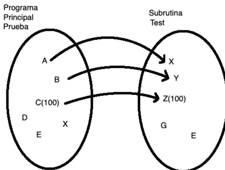
**Figura 11.1.** Esquema de como las variables de los argumentos de la llamada a una subrutina son reasignados a las variables de esta. Note que cada variable debe ser del mismo tipo y dimensionalidad que en el programa principal. La variable E de la subrutina desconoce que existe una variable también llamada E en el programa principal.
