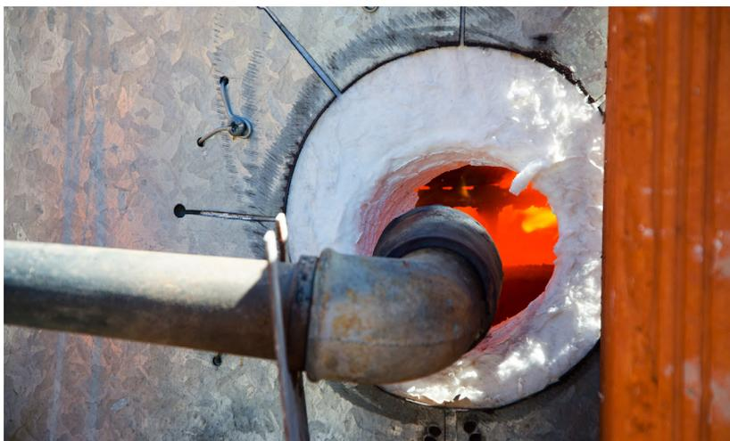
Imagen 6 . Mechero de gas y mirilla del horno para Raku.
