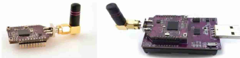
Fig. 1: A la izquierda se observa el módulo OpenMote-cc2538 utilizado, a la derecha se encuentra montado sobre la placa OpenUSB.
