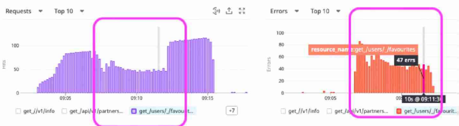
Figura 7: Circuit breaker en estado abierto evita peticiones hacia Favourites-service
