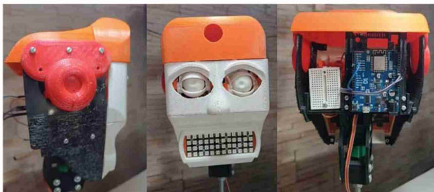
Fig. 11. Cabeza robot terminada y vista del controlador IoT.
