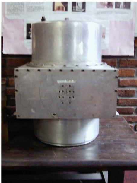
Figura 5 Detector de radiación neutra.
