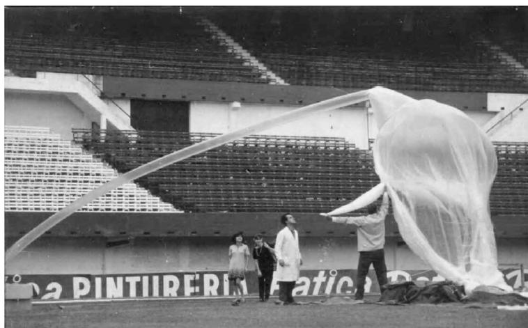
Figura 7 Lanzamiento de un globo estratosférico. Desde la izquierda hacia el centro de la imagen se visualiza la manga con la que se llenaba la burbuja de gas, que aparece hacia la derecha. Aparecen en la foto L. Opradolce, C. Falcón y Vicente Mugherli.
