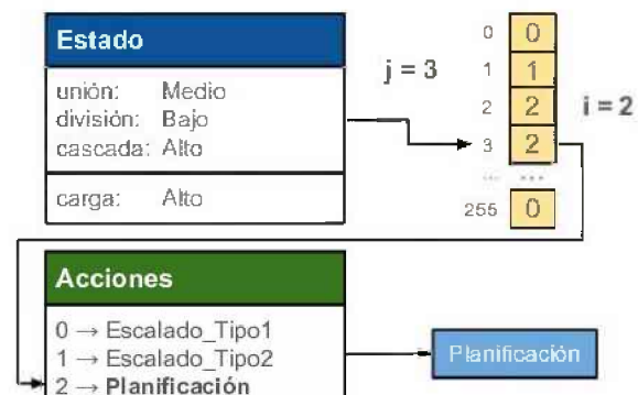
Figura 2: A partir de un modelo de AR existente [1] se diseñó una codificación de políticas para ser optimizadas con algoritmos evolutivos multiobjetivo (ReLIEF) [3]
