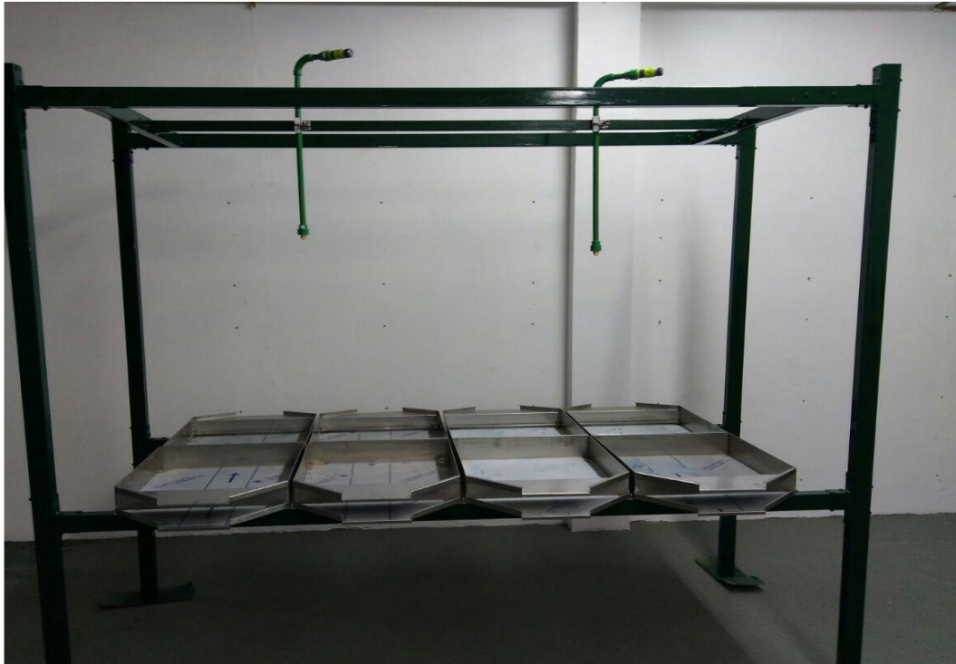
Figura 2.5. Simulador de lluvias de laboratorio del Centro de Estudios de la Dinámica Exógena (CEIDE – FCAF-UNLP). Fuente: Elaboración propia.
