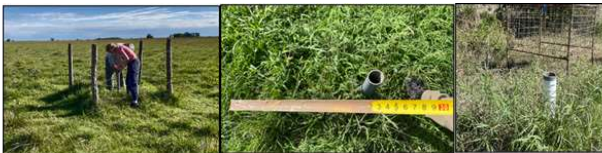
Figura 4.25 Freatómetros del bajo (izq.), media loma (medio) y loma (der)
