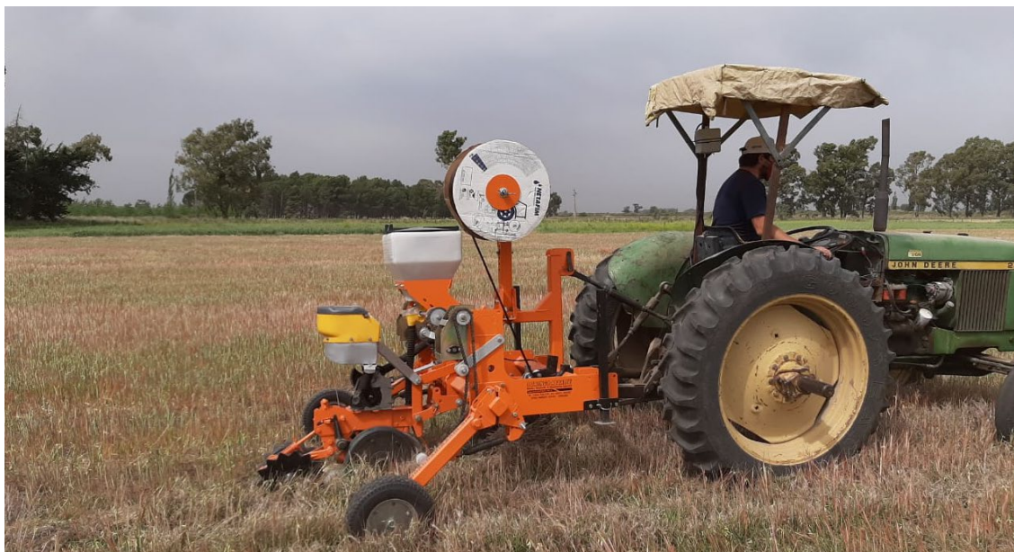
Imagen 7. Sembradora de siembra directa de zapallo con equipo de fertilización y riego por goteo incorporado (Fuente: Imágenes Propias).
