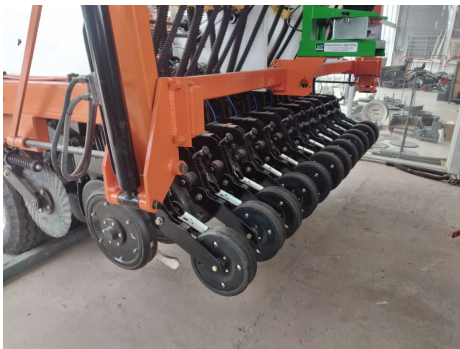
Imagen 3. Sembradora de cebolla para labranza cero (Izq) Sembradora de SD de granos finos (Der) (Fuente: Imágenes Propias).
