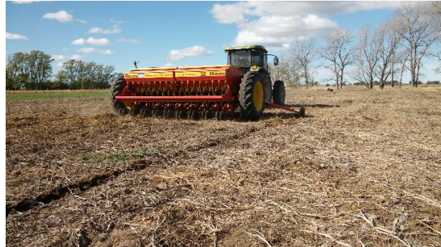
Imagen 3. Sembradora de cebolla para labranza cero (Izq) Sembradora de SD de granos finos (Der) (Fuente: Imágenes Propias).
