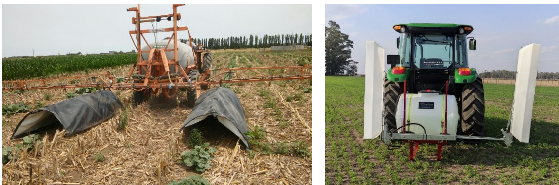
Imagen 8. Aplicación de glifosato con picos anti-deriva y pantallas protectoras sobre las líneas del cultivo (Fuente: Imágenes Propias).
