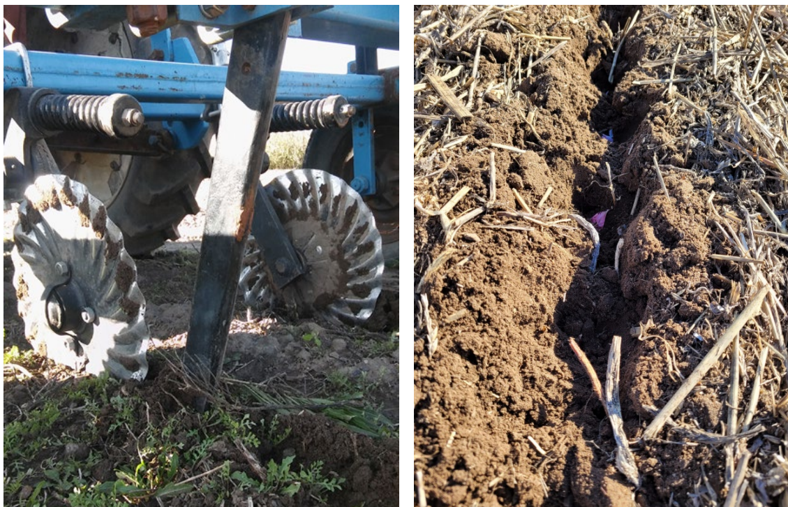
Imagen 1. Implemento abre-surco para la plantación de ajo (Izq.) Línea de siembra sembrada a mano que luego se cubre con la pasada de rolo (Fuente: Imágenes Propias).
