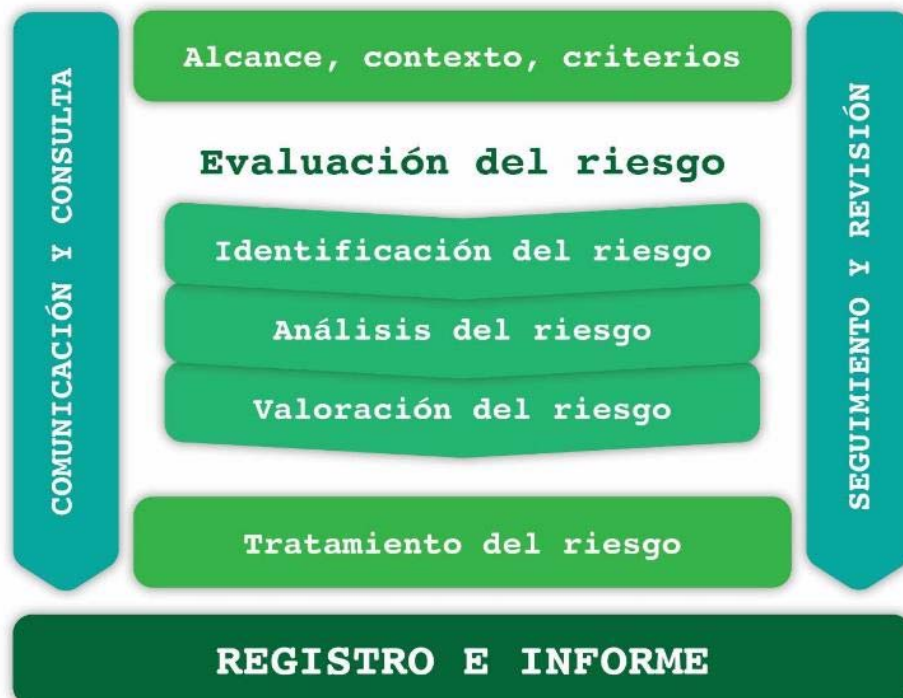
Figura 12.1. Proceso de gestión del riesgo. Adaptado de la Norma ISO 31000/2018
