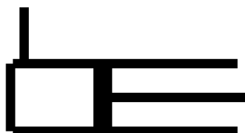
Figura 201: Simbología para un cilindro de simple efecto
