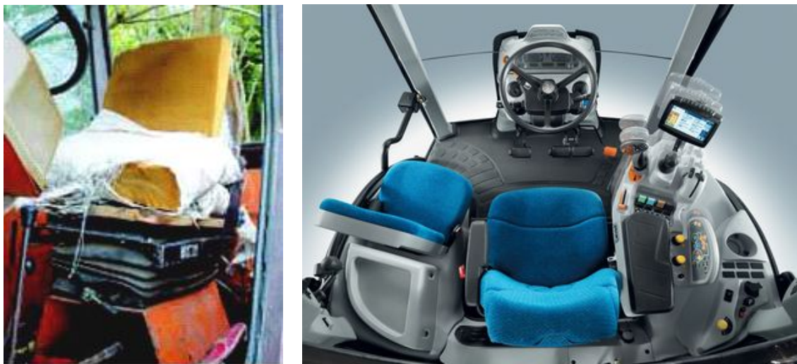
Figura 86: Puesto de conducción muy poco confortable (Izquierda) y cabina de tractor confortable y con mandos concentrados en panel ubicado a la derecha lo que reducirá los riesgos por fatiga (Derecha)
