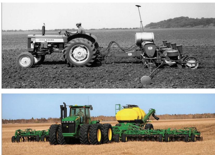
Figura 190: Sembradora para sistemas convencionales (con labranza) arrastrada por tractor convencional (Arriba) Sembradora para siembra directa tipo Air Drill arrastrada por tractor articulado con duales (Abajo)
