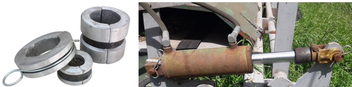
Figura 205: Topes para limitar el recorrido de los cilindros hidráulicos (Izquierda) Torno que limita el recorrido del cilindro hidráulico (Derecha) Ambos elementos son usados para controlar la profundidad en cilindros de control remoto
