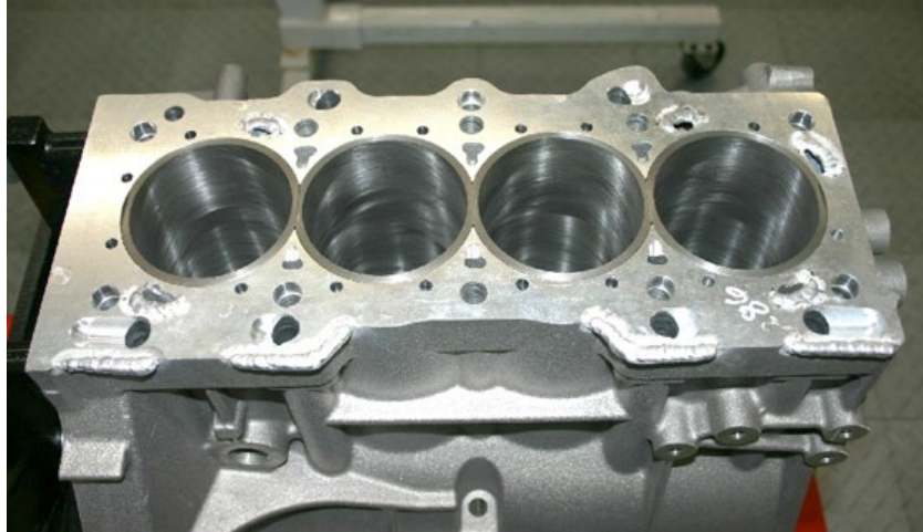
Figura 3: Block de un motor de 4 cilindros con camisas
