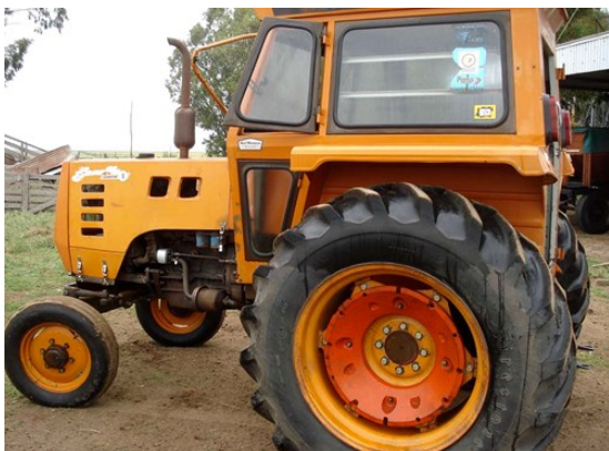
Figura 154: Posibilidad de variación de trocha por concavidad del disco (Izquierda) y excentricidad de fijación en la llanta con dos posibles puntos de fijación (Derecha)
