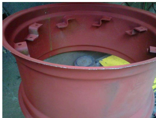
Figura 154: Posibilidad de variación de trocha por concavidad del disco (Izquierda) y excentricidad de fijación en la llanta con dos posibles puntos de fijación (Derecha)
