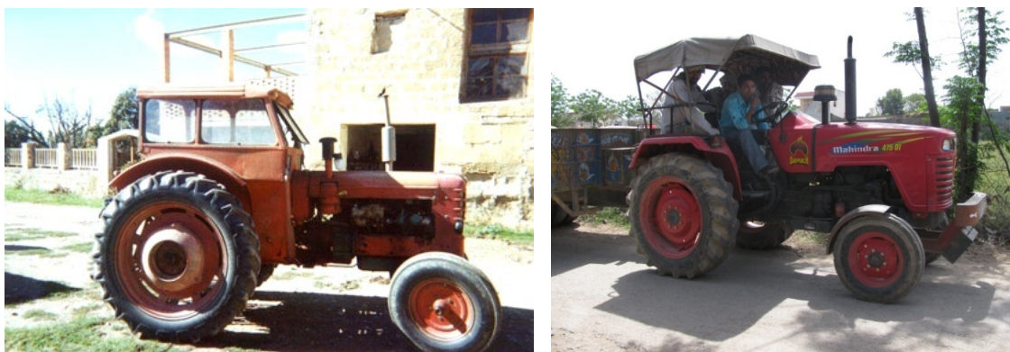
Figura 104: Tractores con cabina (Izquierda) y techo (Derecha) que no protegen del vuelco
