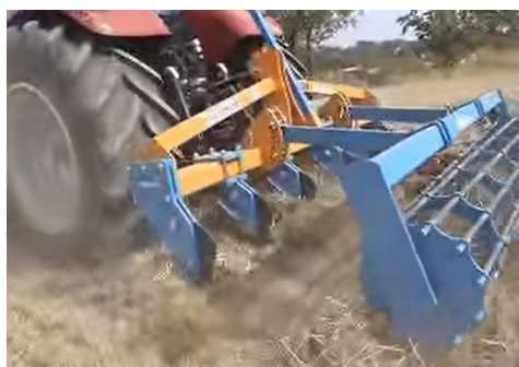
Figura 227: Equipos montados que se trabajan en control de carga. Descompactador con rolo (Izquierda) Arado de reja y vertedera reversible (Derecha)
