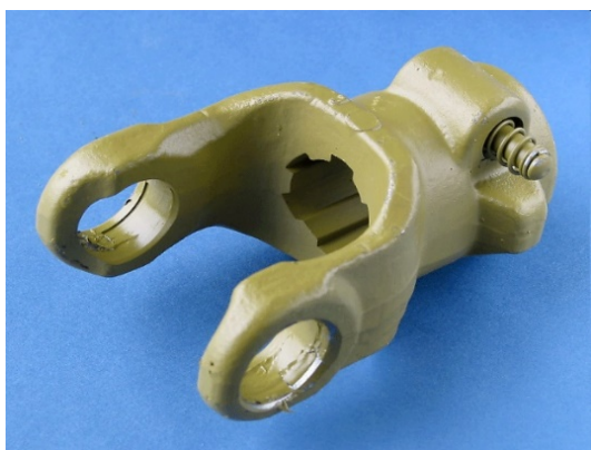
Figura 158: Hembra para toma categoría I. Se aprecia el seguro con resorte en la parte superior que debe oprimirse en el momento de acople (Izquierda) Cuando no se usan las TPP es bueno que estén cubiertas por capuchones para evitar accidentes (Derecha)
