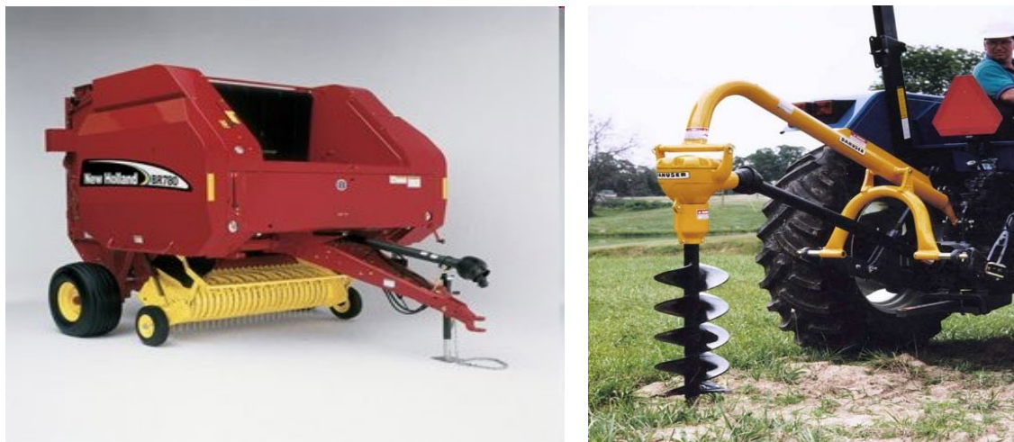
Figura 162: Rotoenfardadora accionada por TPP (Izquierda) Hoyadora montada accionada por la TPP (Derecha)
