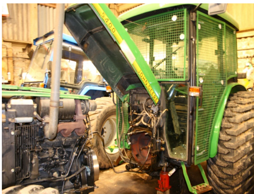
Figura 173: Tractor partido para acceder al recambio del embrague
