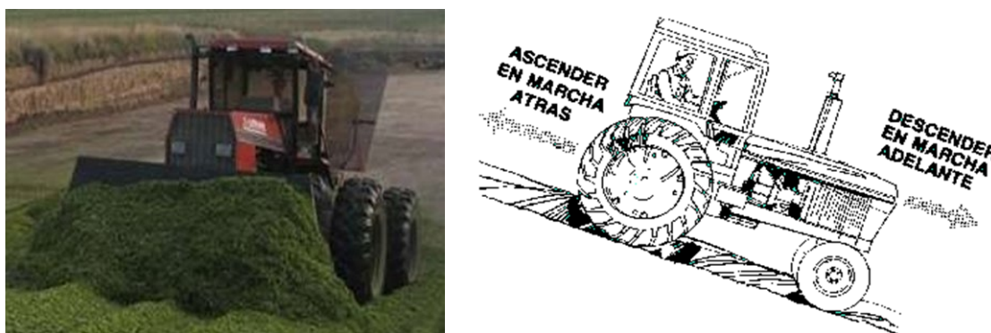
Figura 97: Situación de vuelco generada en la compactación de silos (Izquierda) Recomendación de maniobra para reducir el riesgo de vuelco ante pendiente excesiva anteroposterior (Derecha)
