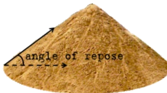
Figura 240: Talud de un suelo arenoso. El ángulo que forma la pila es el ángulo de roce interno \phi
