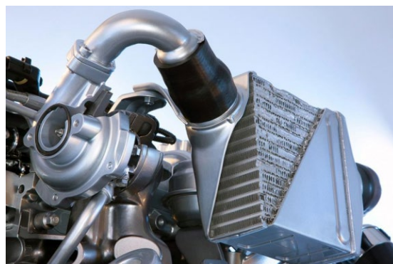
Figura 27: Esquema de intercooler o postenfriado aire-aire (Izquierda) y ubicación a posteriori del turbo (Derecha)
