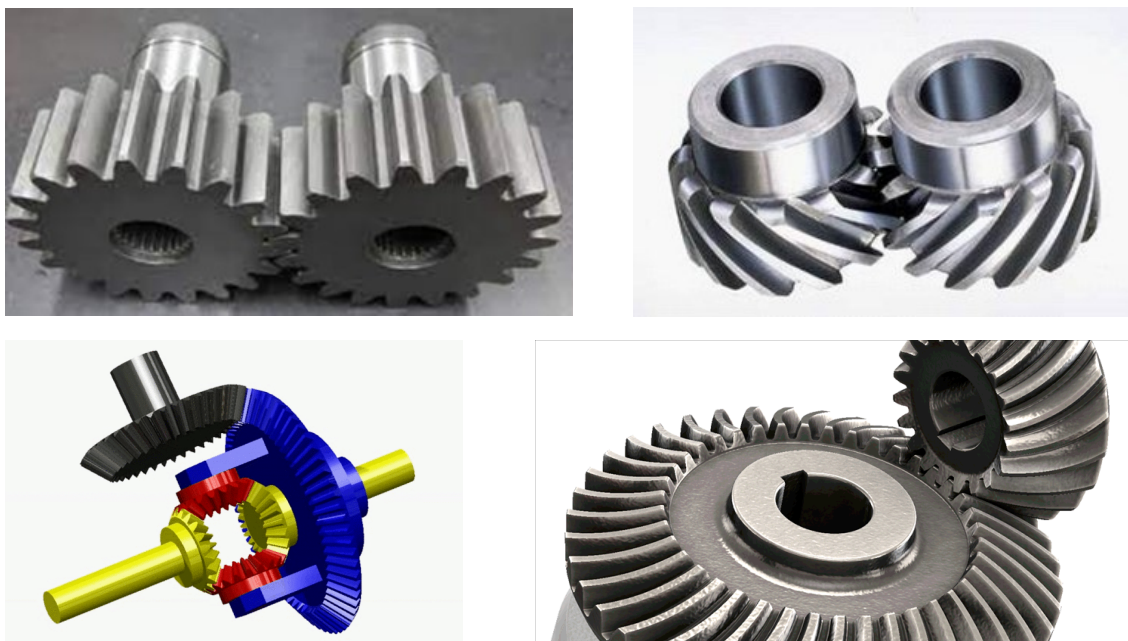
Figura 117: Engranajes cilíndricos de dientes rectos (Arriba Izquierda) y helicoidales (Arriba Derecha). Engranajes cónicos de dientes rectos formando parte de un diferencial (Abajo Izquierda), y engranajes cónicos de dientes helicoidales (Abajo Derecha)
