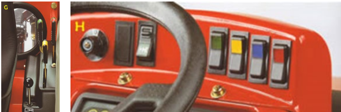
Figura 207: Mandos del sistema hidráulico. Palancas (Izquierda) Teclas (Derecha)
