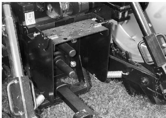
Figura 158: Hembra para toma categoría I. Se aprecia el seguro con resorte en la parte superior que debe oprimirse en el momento de acople (Izquierda) Cuando no se usan las TPP es bueno que estén cubiertas por capuchones para evitar accidentes (Derecha)
