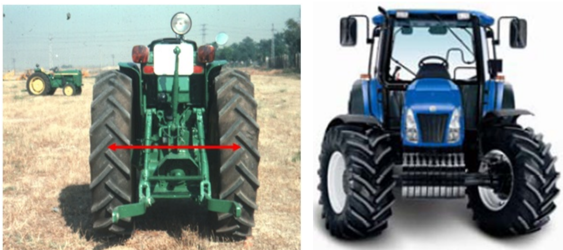
Figura 96: Tractor con trocha escasa (Izquierda) y con trocha importante (Derecha)
