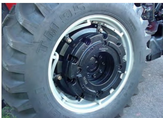
Figura 156: Variación de trocha a través de correderas helicoidales ubicadas sobre la llanta. Izquierda: Fotografía donde se ven los helicoides. Derecha: esquema mostrando 1) Guía que desliza sobre el helicoides 2) y 3) Helicoides sobre la llanta 4) Fijaciones al helicoides 5) Posiciones posibles sobre el helicoides
