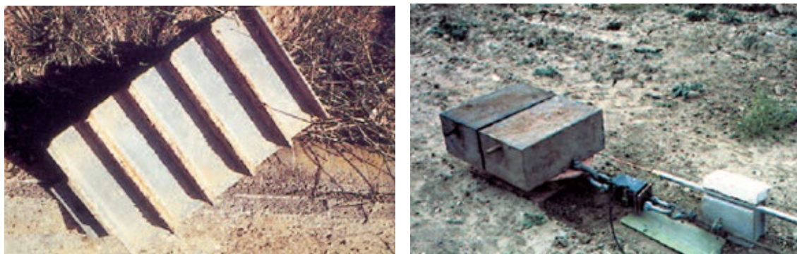
Figura 235: Anillo de aletas radiales (Izquierda) Molinete torsor de paletas (Derecha) A ambos dispositivos se les aplica un momento torsor
