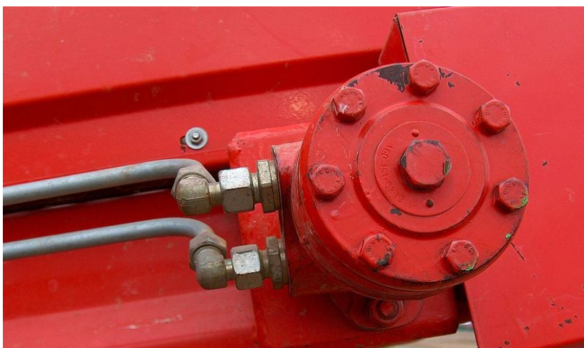
Figura 168: Motor de pistones radiales que gobierna el avance/retroceso de una pulverizadora autopropulsada. Se aprecian las dos vías por las que ingresa y sale el aceite
