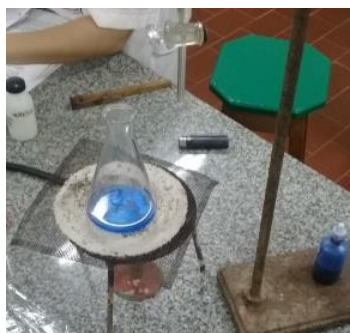
Figura 6.8. Cuantificación de azúcares reductores a partir del método de FCB: etapa de titulación. En este ejemplo se agregó a la bureta la glucosa patrón (frasco plástico). En el Erlenmeyer puede observarse el color inicial del reactivo de FCB (azul claro), que además contiene plato poroso. A derecha se encuentra el gotero conteniendo al azul de metileno (indicador redox), de color más intenso que el reactivo. El \text{Cu}^{2+} del reactivo de FCB es reducido por los azúcares agregados desde bureta. El indicador facilita la visualización del punto final.
