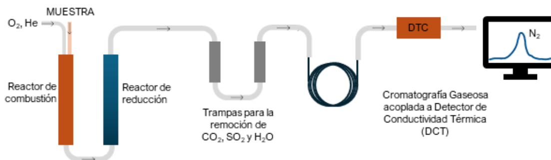
Figura 7.3. Esquema correspondiente a la determinación de nitrógeno por el método de Dumas en métodos automatizados, con cuantificación por cromatografía gaseosa.
