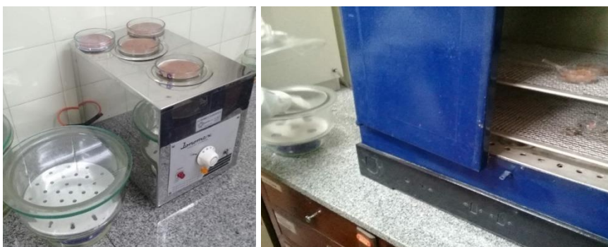
Figura 4.3. Concentración de muestras líquidas sobre arena en baño termostático a modo de pre-tratamiento (izquierda) y deshidratación en estufa (derecha) para determinar humedad.
