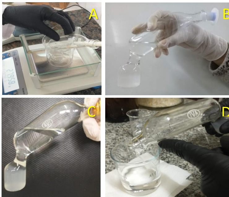
Figura 8.3. Secuencia de pasos para la extracción de Rose Gottlieb con Tubo Mojonnier (A) Pesada de la muestra. (B) Etapa de extracción con agitación. (C) Etapa de separación de las fases. (D) Separación y recolección de los extractos. Fuente: Laboratorio del Área Bioquímica y Control de Alimentos de la Facultad de Ciencias Exactas de la UNLP.
