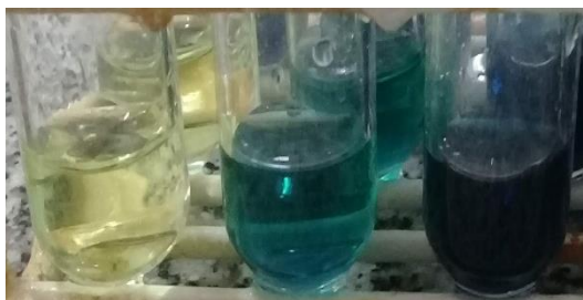
Figura 6.5. Colores típicos observados en la cuantificación de azúcares totales por el método de antrona: 1) ausencia de azúcares (amarillo pálido), 2) presencia de azúcares dentro de la recta de calibración (verde característico) y 3) presencia de azúcares en exceso. El medio ácido fuerte deshidrata los azúcares que a 100 °C se ciclan y forman furfurales los cuales condensan con la antrona generando un complejo de color verde que absorbe a 620 nm.
