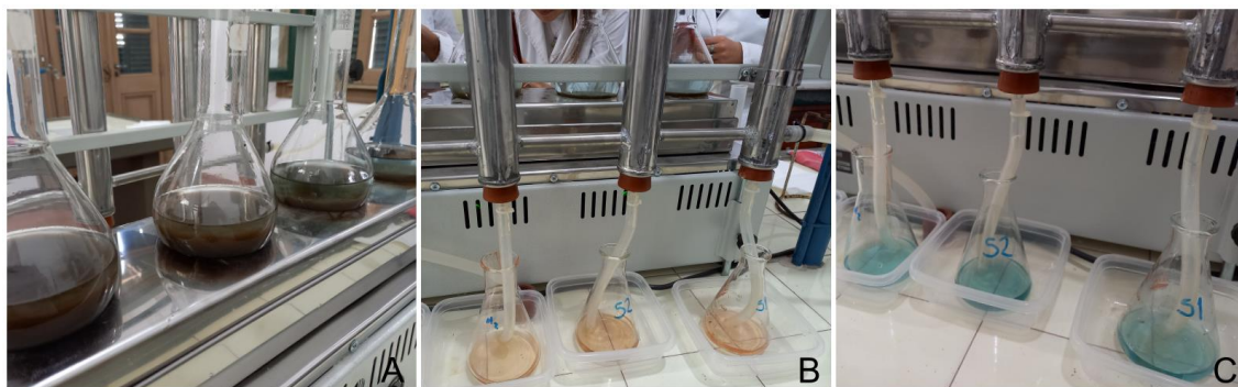
Figura 7.2. Unidad de destilación. A. Balones antes de comenzar el calentamiento. B Erlenmeyers con solución de ácido bórico al inicio del calentamiento. C. Erlenmeyers con solución de ácido bórico de color turquesa dado por el viraje del indicador de Mortimer a medida que el amoníaco de la muestra destila. Fuente: Laboratorio del Área Bioquímica y Control de Alimentos, Facultad de Ciencias Exactas, UNLP.
