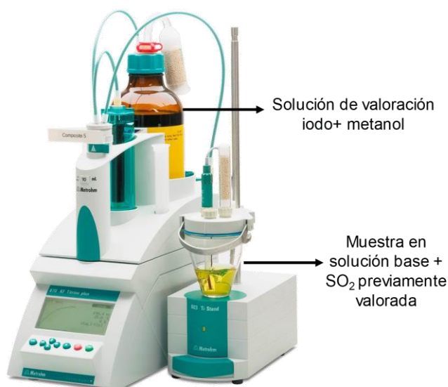
Figura 5.4. Equipo de Karl-Fischer para determinación de humedad (adaptado de Scancotec Productos, 2024)
