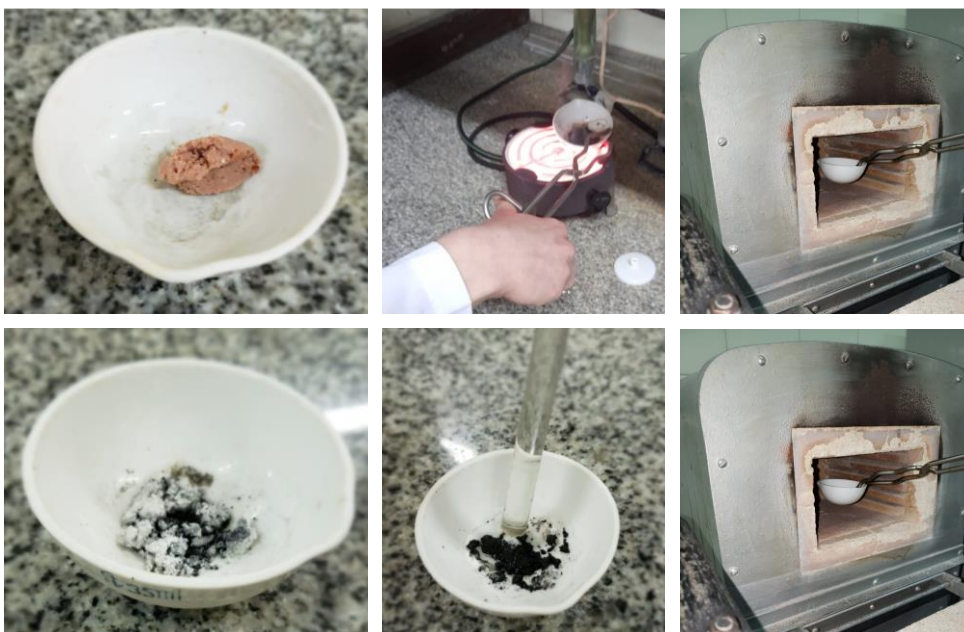
Figura 5.8. Determinación de cenizas en una muestra pastosa. Se pueden observar la presencia de partículas carbonosas (puntos negros) luego del primer ciclo de calentamiento. Estos debieron ser dispersados mediante la humectación y el uso de una varilla previo al segundo ciclo de incineración en mufla. Fuente: propia
