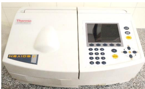
Figura 6.4. Espectrofotómetro UV-visible (Thermo, Helios). Se fija la absorbancia (a derecha) y esta se lee una vez levantando la tapa, colocando la/s cubeta/s y bajando la tapa (a izquierda).
