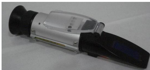
Figura 5.5. Refractómetro que puede ser utilizado para determinación de humedad en miel (gentileza de M.C. Mouteira, 2024).
