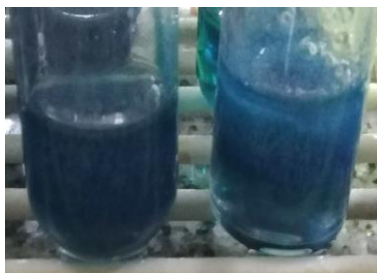
Figura 6.6. Tubos de ensayo mostrando el color del producto obtenido por el método de SN (azul de molibdeno), cuya intensidad es proporcional a la cantidad de azúcares reductores.
