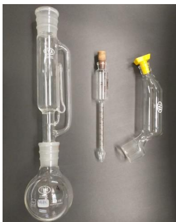
Figura 4.5. Sistemas extractores del método de Soxhlet (Balón y tubo de solvente, izquierda), Gerber (butirómetro, centro) y Rose-Gottlieb (Tubo de Mojonnier, derecha). Fotografía: propia.
