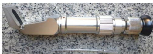
Figura 6.2. Refractómetro óptico. Se coloca una gota de muestra en el extremo izquierdo, se baja la tapa y se lee desde el extremo derecho el valor numérico en una escala graduada.
