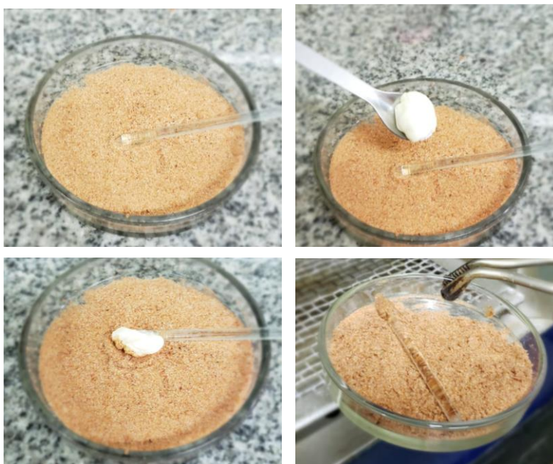
Figura 5.2. Tratamiento con arena realizado a una muestra de queso crema previo al secado en estufa para la determinación de humedad. Fuente: propia
