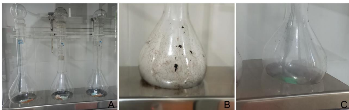
Figura 7.1. Unidad de calentamiento en la que se realiza la etapa de digestión en el método de Kjeldahl. A. Balones conectados a salida de gases, B. Balón en proceso de digestión, C. Balón con la etapa de digestión finalizada. Fuente: Laboratorio del Área Bioquímica y Control de Alimentos, Facultad de Ciencias Exactas, UNLP.
