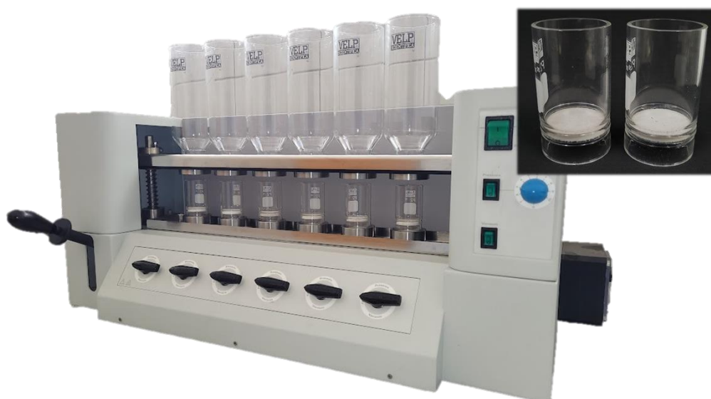
Figura 9.4. Unidad de filtración y detalle de filtros para la determinación de fibra dietaria total.
