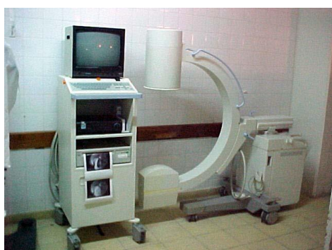
Figura 1.2: Equipo portátil de radioscopia con impresión en papel, que empleamos para guiar la exploración de vía biliar
