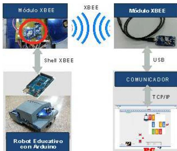
Figura 1. Esquema del sistema robótico educacional
