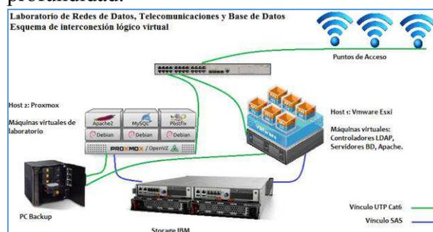
El dispositivo de Storage o Almacenamiento de Datos compartido en Red (SAN) estará integrado a los dos Hosts mediante conexiones SAS a 6.0 GBps, a los efectos de acceder a los volúmenes de datos compartidos, mediante protocolos NFS, iSCSI, SAS. Este equipo alojará las imágenes de máquinas virtuales a nivel Laboratorio, los volúmenes con datos de los Servidores SQL, las carpetas de usuario, entre otros.
