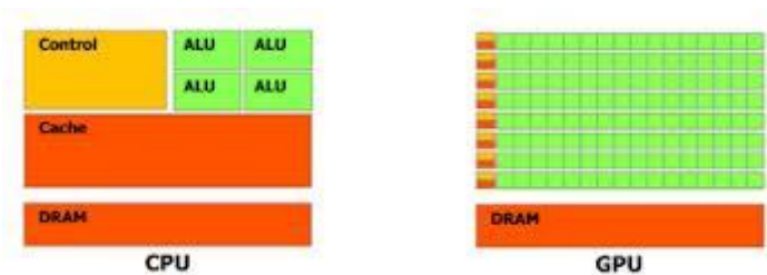
Figura 4.1: Arquitectura CPU vs Arquitectura GPU
