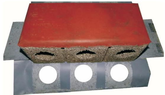
Figura 2. Bloque de Hormigón con EPS con terminación
