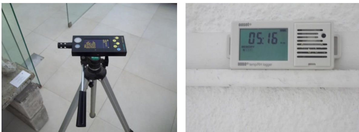
Figura 11. Environmental Monitor y datalogger utilizados durante el monitoreo ambiental edilicio.
