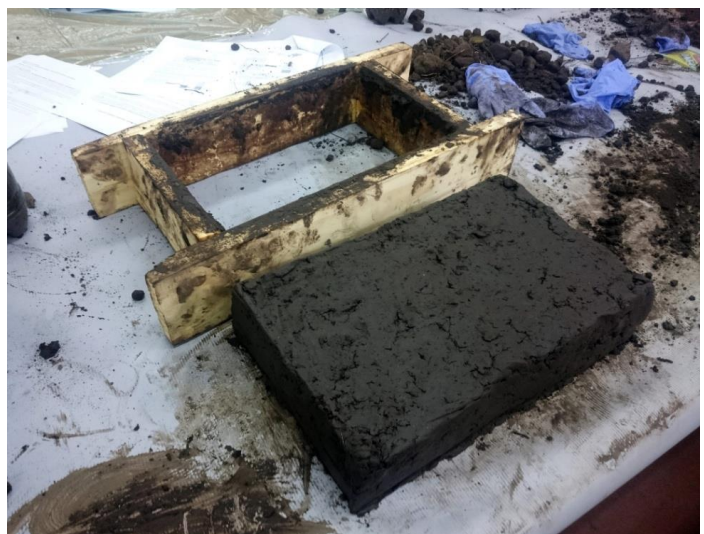
Figura 4. Desmolde de Adobes
