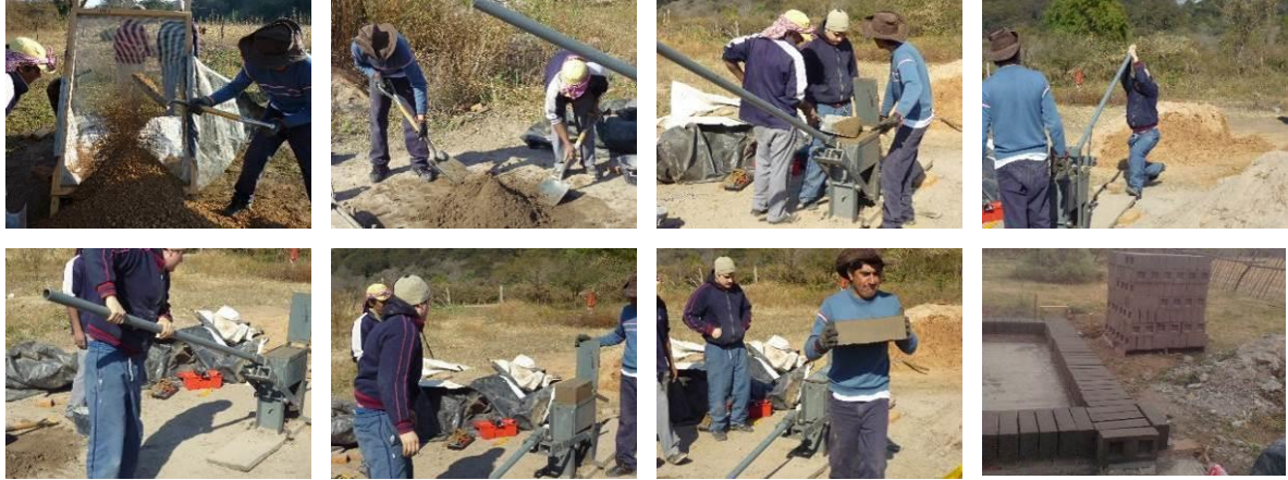
Figura 4. Proceso de fabricación de Bloques de Suelo Cemento
