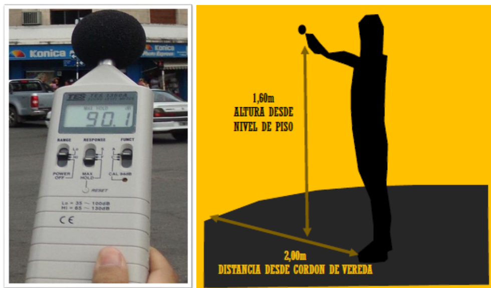
Figura 6. Sonómetro. Protocolo de Medición
