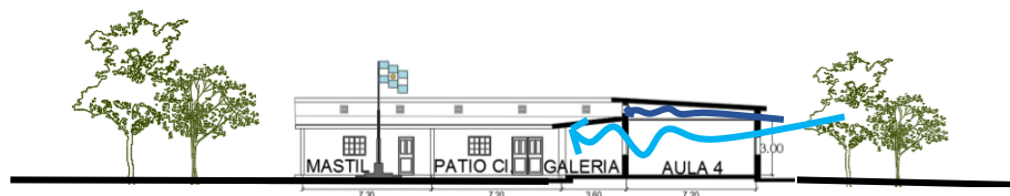
Figura 14: Corte Transversal–Ventilación cruzada
