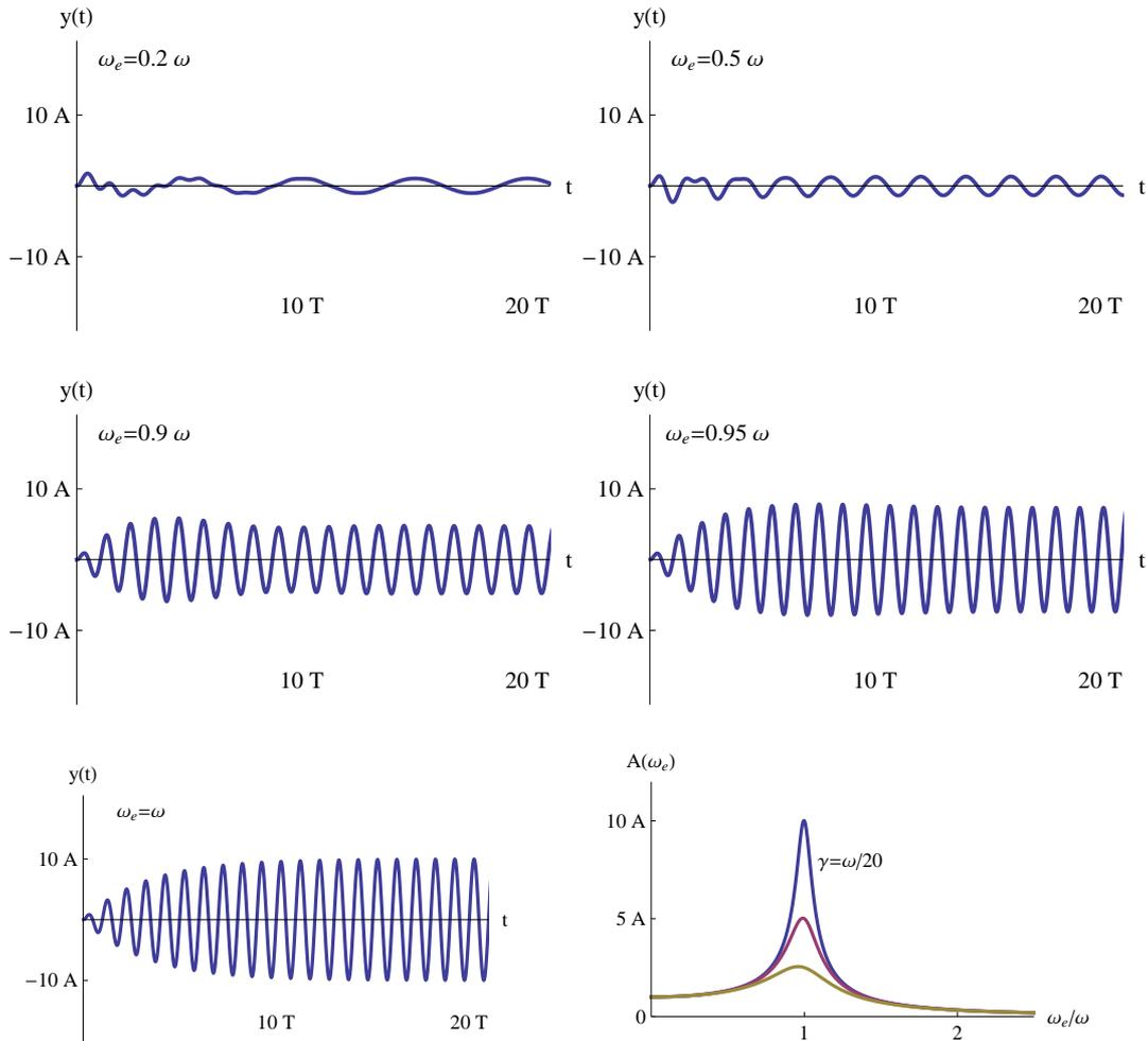
Figura 14: Gráficos de la solución en presencia de roce viscoso con  $\gamma = \omega/20$  para  $y(0) = y'(0) = 0$ . La última figura (II.5.43) muestra la amplitud de la solución particular en función de la frecuencia externa para  $\gamma = \omega/20, \omega/10$  y  $\omega/5$ . Es máxima para  $\omega_{ex} \approx \omega$ .
