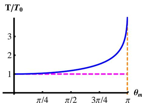
Figura 10: Gráfico del período exacto del péndulo, ecuación (II.3.30), en función de la amplitud  $\theta_m$ . Aquí  $T_0 = 2\pi\sqrt{l/g}$  es el período obtenido en la aproximación lineal (II.3.32), independiente de  $\theta_m$  (línea horizontal). El período exacto tiende a infinito para  $\theta \rightarrow \pi$ .
