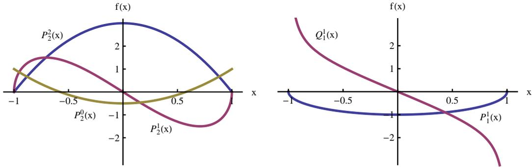
Figura 18: Izquierda: Gráficas de las funciones asociadas de Legendre  $P_2^2(x) = 3(1-x^2)$ ,  $P_2^1(x) = -3x\sqrt{1-x^2}$ ,  $P_2^0(x) = (3x^2 - 1)/2$ . Derecha: Las dos soluciones linealmente independientes de (III.2.29) para  $m = l = 1$ ,  $P_1^1(x) = -\sqrt{1-x^2}$ ,  $Q_1^1(x) = \sqrt{1-x^2}[\frac{1}{2} \ln \frac{1-x}{1+x} - \frac{x}{1-x^2}]$ .
