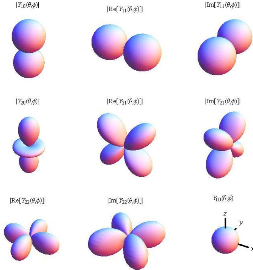
Figura 45: Módulo de los armónicos esféricos. Se grafica la superficie  $r = |Y_{lm}(\theta, \phi)|$  para  $m = 0$ , y  $r = \frac{|\operatorname{Re}[Y_{lm}(\theta, \phi)]|}{|\operatorname{Im}[Y_{lm}(\theta, \phi)]|}$  para  $m \neq 0$ , para  $l = 0, 1, 2$ . La orientación de los ejes (igual en todos los paneles) es indicada en el último panel.
