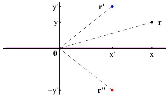
Figura 49: Método de las imágenes para el semiplano.
