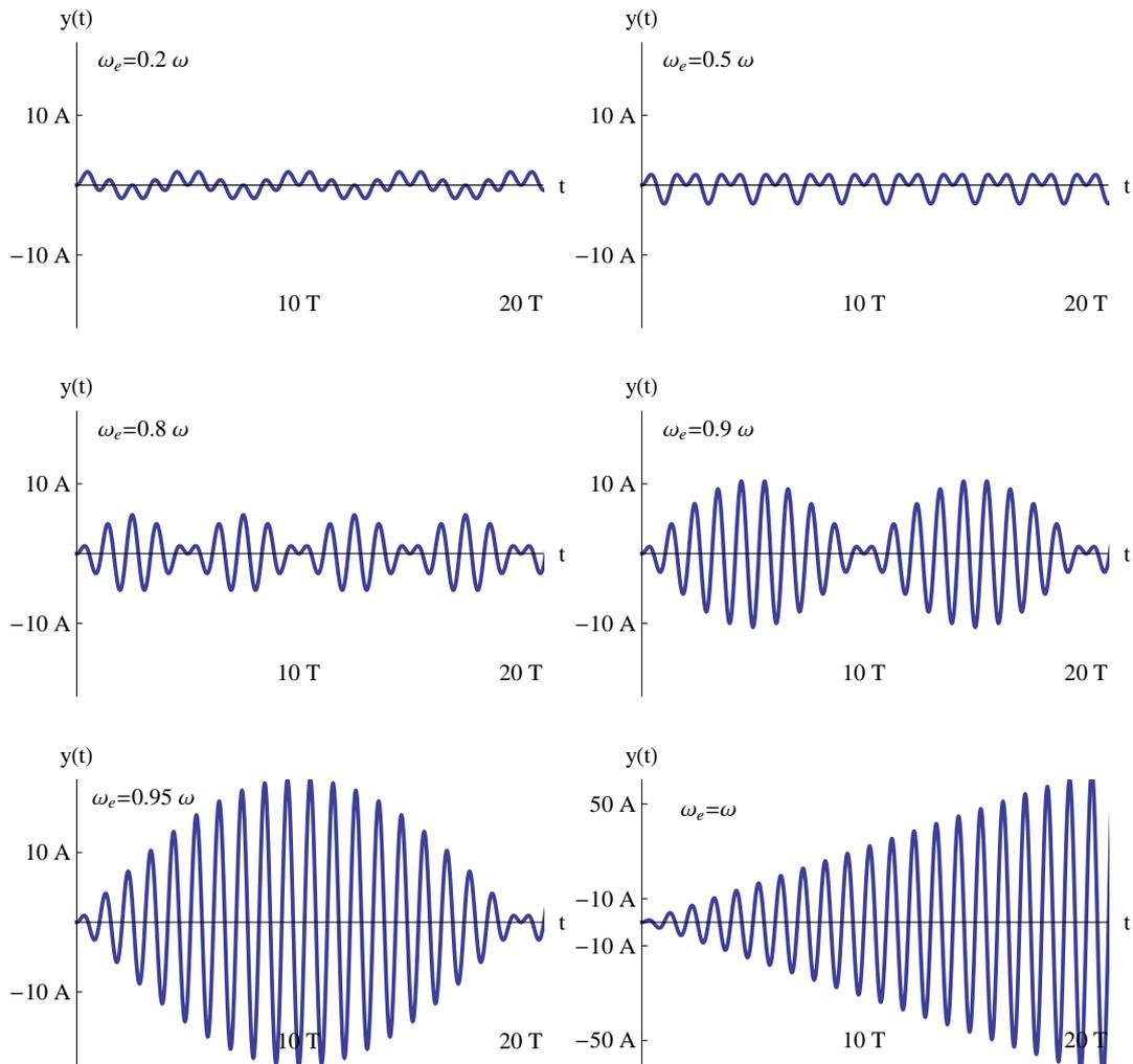
Figura 13: Gráficos de la solución (II.5.43) para distintas frecuencias externas  $\omega_e$  e intensidad  $f$  fija. Nótese el cambio de escala en el caso resonante  $\omega_e = \omega$ .  $T = 2\pi/\omega$  es el período y  $A = f/\omega^2$ .
