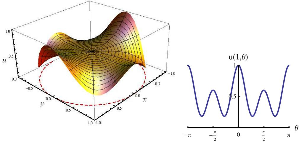
Figura 42: Gráfico de la función armónica  $u(r, \theta)$  (izquierda) en el interior del círculo de radio 1 que satisface  $u(1, \theta) = \alpha + \beta \cos 2\theta + \gamma \sin 4\theta$ , con  $\alpha = 0,5$ ,  $\beta = 0,2$ ,  $\gamma = 0,3$ . Nótese que  $u(r, \theta)$  no tiene máximos ni mínimos locales, alcanzando su valor máximo y mínimo en el borde. En el centro ( $r = 0$ ),  $u = 1/2$ , que es el valor medio en el borde. Se deja como ejercicio dar la expresión de  $u(r, \theta)$ .
