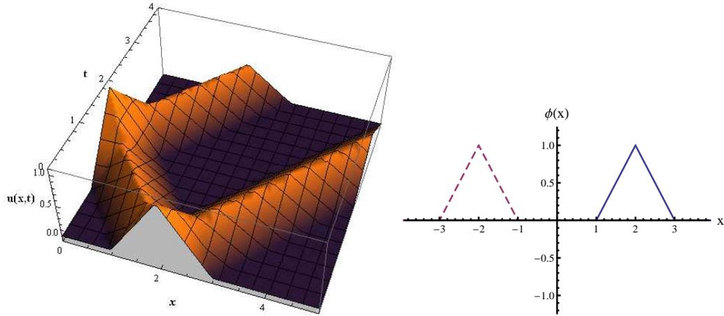
Figura 32: Izquierda: La deformación  $u(x, t)$  en la región física para una cuerda semi-infinita con extremo libre, con deformación inicial triangular y perfil inicial de velocidades idénticamente nulo ( $v = 1$ ). Pueden observarse la reflexión sin cambio de signo y el comportamiento de la derivada con respecto a  $x$  en  $x = 0$ . Derecha: La correspondiente extensión par de la condición inicial.
