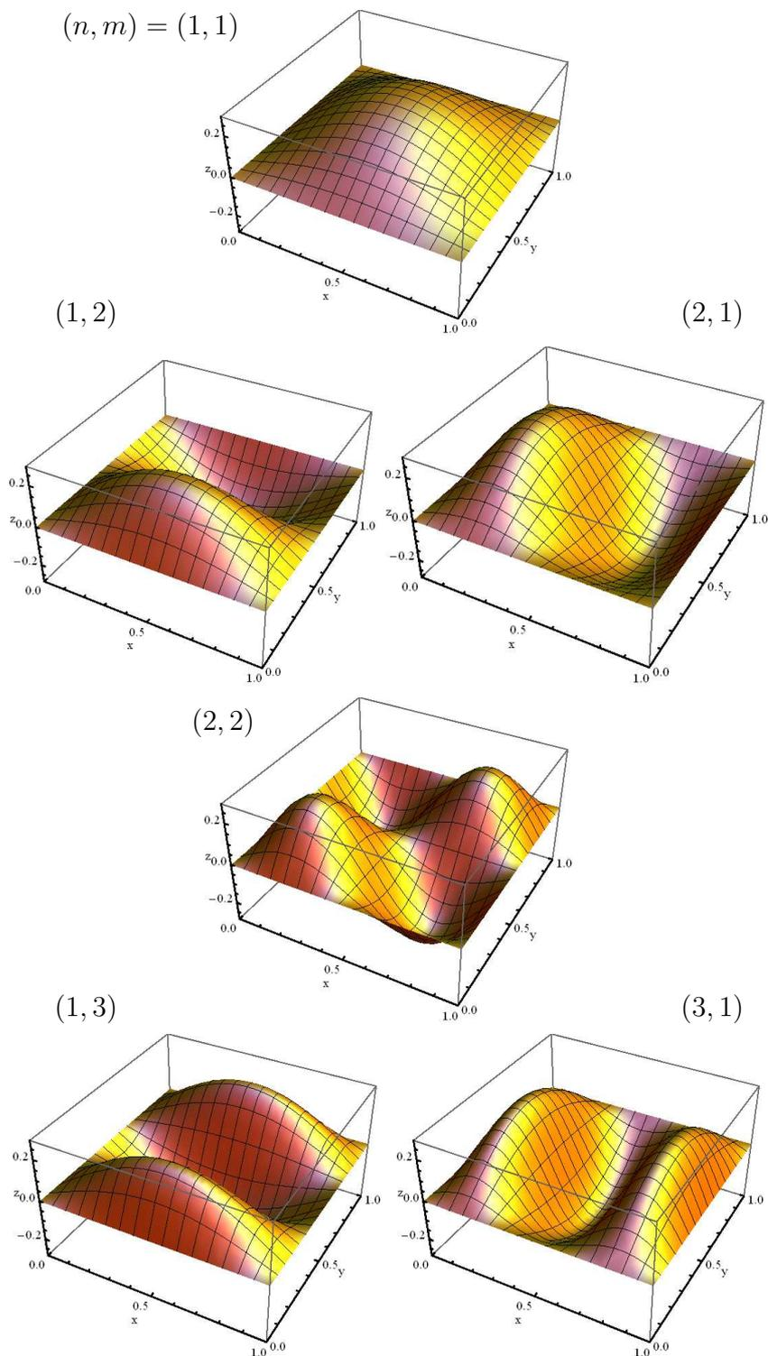
Figura 47: Las primeras seis autofunciones  $u_{nm}(x, y)$  del laplaciano en un cuadrado de lado 1, dadas por (v.6.47). Los autovalores son  $\lambda_{nm} = \pi^2(n^2 + m^2)$ . Estas autofunciones representan, por ejemplo, los primeros modos normales de vibración de una membrana cuadrada fija en los bordes, siendo las frecuencias de vibración proporcionales a  $\sqrt{\lambda_{nm}}$ .
