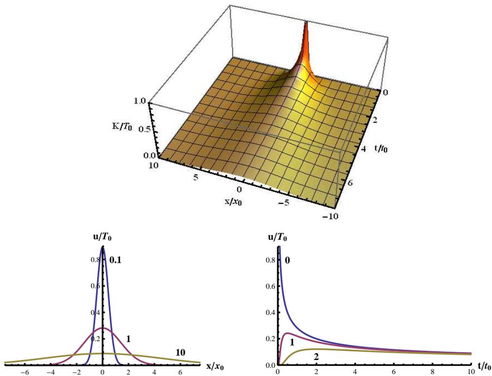
Figura 35: Gráfico de la función respuesta  $K(x, t)$  de la ecuación de difusión en la barra infinita ( $t_0$  y  $x_0$  son unidades tales que  $\alpha t_0/x_0^2 = 1$  y  $T_0$  es la unidad de temperatura.). Abajo se muestran los perfiles en función de  $x/x_0$  para tiempos fijos  $t/t_0 = 0,1, 1$  y  $10$ , y en función de  $t/t_0$  para posiciones fijas  $x/x_0 = 0, 1, 2$ .
