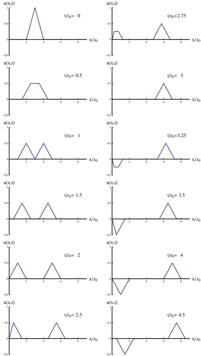
Figura 31: Perfil de una cuerda semi-infinita con extremo fijo para distintos tiempos. Aquí,  $x_0$  y  $t_0$  son unidades de espacio y tiempo tales que  $vt_0 = x_0$ .
