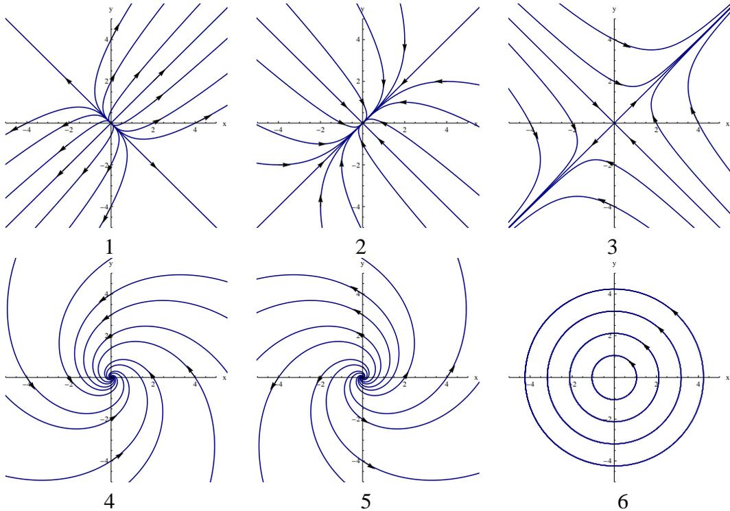
Figura 11: Gráficos de las soluciones del sistema (II.4.46) para  $a = d$ ,  $|\alpha| = |\beta|$ . Las flechas indican el sentido del movimiento. Los gráficos corresponden a: 1) Ambos autovalores reales y positivos, 2) Ambos reales y negativos, 3) Uno positivo y uno negativo, 4) Complejos con parte real negativa, 5) Complejos con parte real positiva, 6) Imaginarios.
