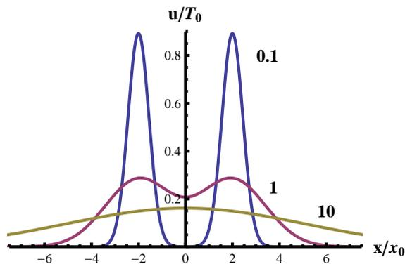
Figura 36: Perfil de la temperatura  $u(x, t)$  en la barra infinita para temperatura inicial  $u(x, 0) = \delta(x - 2x_0) + \delta(x + 2x_0)$  a tiempos  $t/t_0 = 0,1, 1$  y  $10$ . Se observa que las irregularidades iniciales son fuertemente atenuadas al aumentar el tiempo, no quedando prácticamente indicios del doble pico inicial para tiempos grandes  $t/t_0 \gg 1$ .
