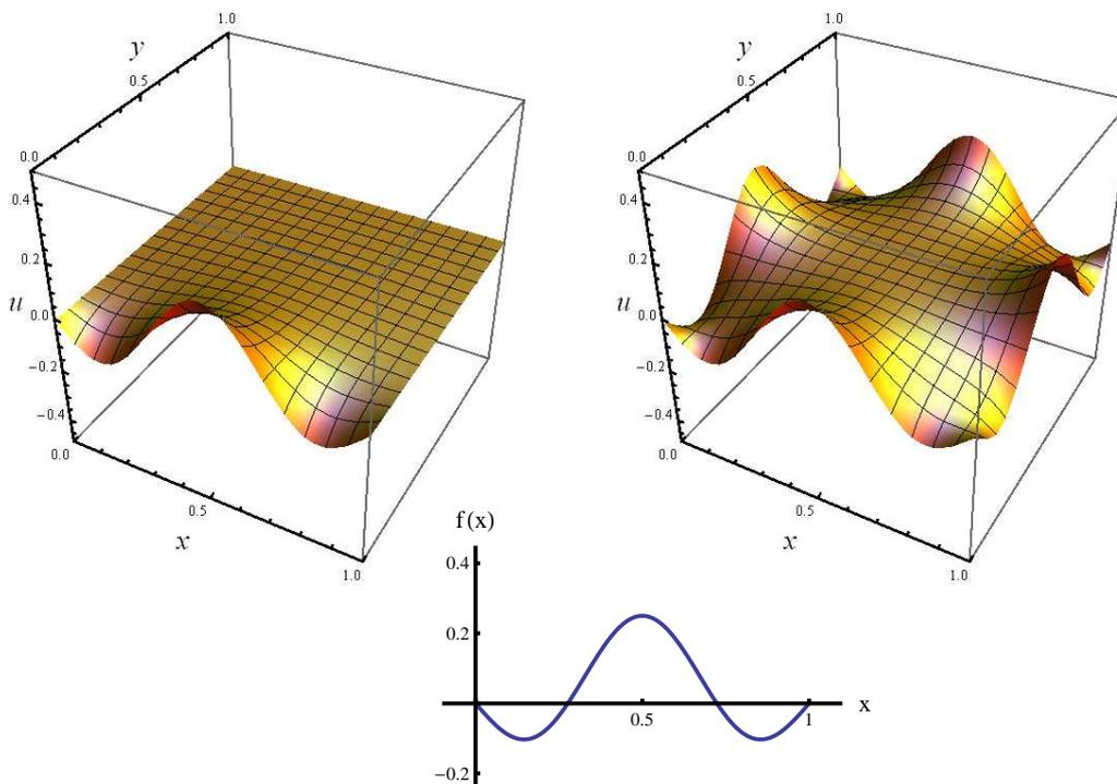
Figura 40: Izquierda: Gráfico de la función armónica en el cuadrado  $0 \leq x \leq 1$ ,  $0 \leq y \leq 1$ , que satisface  $u(0, y) = u(1, y) = u(x, 1) = 0$  y  $u(x, 0) = f(x)$ , con  $f(x) = \alpha \cos \pi x + \beta \sin 3\pi x$  y  $\alpha = 0,1$ ,  $\beta = -0,15$  (centro). Derecha: Gráfico de la función armónica obtenida al repetir dicha función como condición de contorno en los cuatro lados. Se deja como ejercicio dar la expresión de  $u(x, y)$  en ambos casos.
