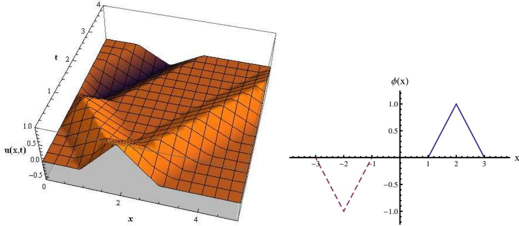
Figura 30: Izquierda: La deformación de una cuerda semi-infinita con extremo fijo en  $x = 0$ , como función de  $x$  y  $t$ , para deformación inicial triangular y perfil inicial de velocidades idénticamente nulo (con  $v = 1$ ). Obsérvese la evolución de los frentes de onda progresivo y regresivo en la región física, así como la reflexión con cambio de signo, que ocurre a partir de  $t = 2$ . Derecha: La correspondiente extensión impar de la condición inicial.
