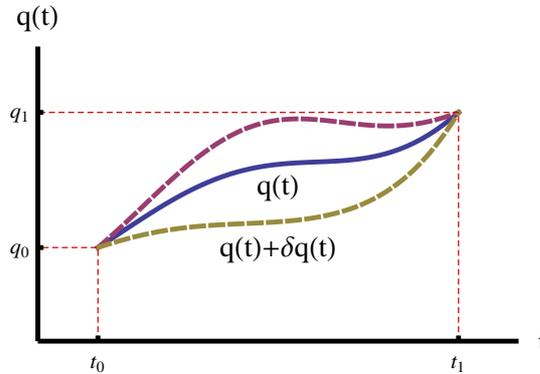
Figura 52: Esquema de  $q(t)$  (curva que minimiza la acción  $S$  entre  $t_0$  y  $t_1$  para  $q(t_0) = q_0$ ,  $q(t_1) = q_1$ ) y de  $q(t) + \delta q(t)$  para dos variaciones distintas  $\delta q(t)$ .
