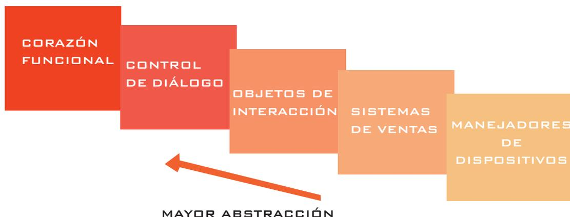
Figura 2.7: Software de la Interfaz del usuario dividido en diferentes capas de abstracción
