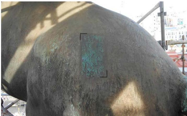
*Figura 43. Prueba de limpieza con EDTA al 5% en agua desmineralizada, sobre pátina marrón. Cuadriga.*
