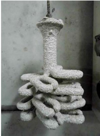
*Figura 52. Molde de racimo en material refractario.*
