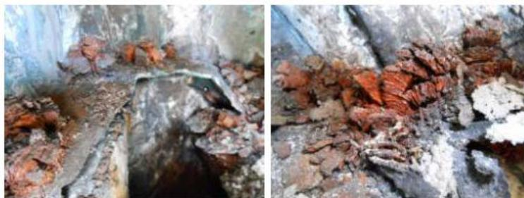
*Figura 61. Estado de bulones internos de unión entre la parte superior de la escultura y la inferior.*
