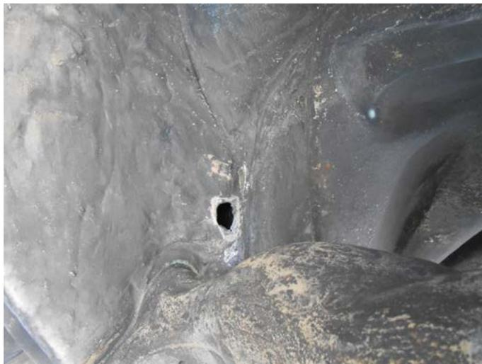
*Figura 20. Orificio por corrosión natural.*
