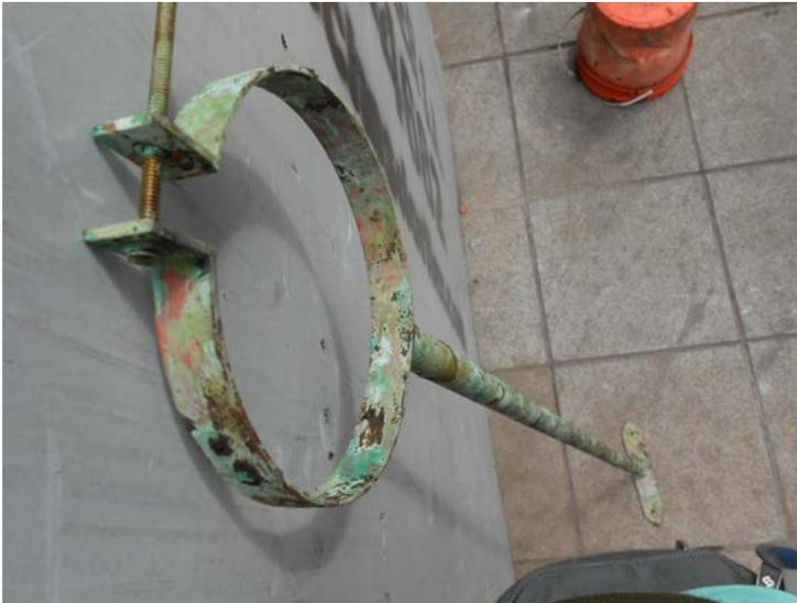
*Figura 54. Pie de eje de carro de reposición patinado artificialmente*
