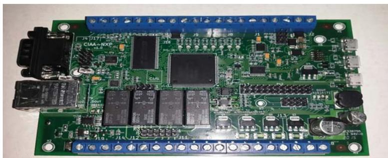
CIAA-NXP: Arquitectura de Hardware utilizada para la realización de la adquisición de datos y automatización de los sistemas móviles de la fabrica.
