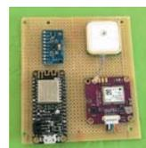
Fig 3.: Prototipo con GPS y acelerómetro
