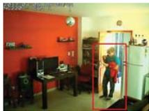
Implementación de un sistema de software de vigilancia añadiendo a un sistema comercial niveles de alarmas basados en la detección de intrusos utilizando un algoritmo de reconocimiento de personas mediante histogramas de gradientes orientados (HOG)
