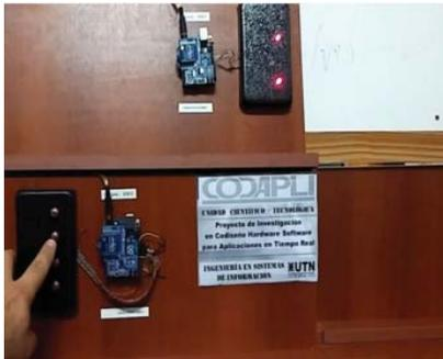
Fig. 2. Prototipo de sistema transmisor-receptor con módulos XBee desarrollado en el laboratorio
