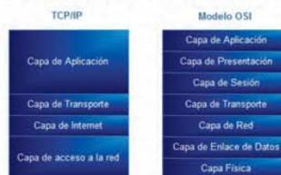
Figura N°1: Comparación del Modelo OSI y TCP/IP
