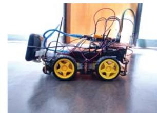
Fig.4: Robot 4 motores y cámara
