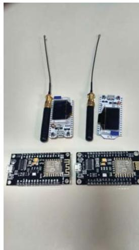
Fig.3: Red de sensores: nodos Lora y NodeMCU
