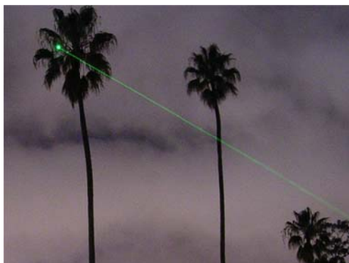
Fig. 13.5. Un puntero láser verde de 5 mW dirigido a una palmera por la noche. El haz es visible a través de la dispersión (scattering).
