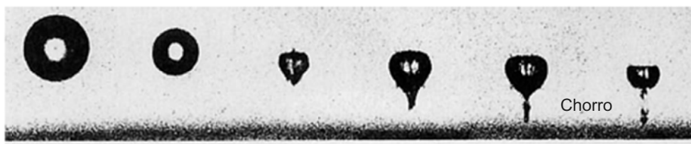
Fig. 12.3. Colapso de una burbuja de cavitación cerca de una pared rígida y formación de un chorro que se dirige hacia ella (Vogel, 1989).
