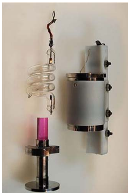
Fig. 2.8. Réplica del láser de Maiman construida en 2010 para festejar los 50 años del láser.
